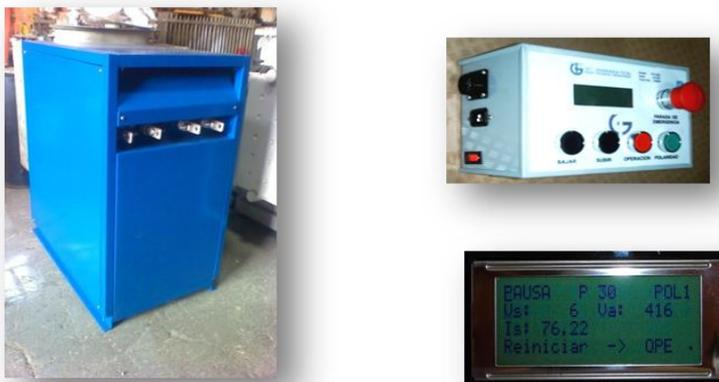
**Figura No 3 Equipo de inyección de corriente (módulo de potencia y de control respectivamente).**
